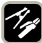
**IGNITION HF (high frequency)** = ignição é uma alta frequência de soldagem TIG sem contato, o que garante uma soldagem começo limpo.
