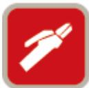
3. **MMA Cable MMA** = manual metal arco de soldadura (EHand / MMA) é um dos mais antigos procedimentos de soldagem elétrica para materiais metálicos, que é usado ainda hoje. Um arco electrónico entre um eléctrodo consumível e um material de enchimento para a peça de trabalho é utilizado como fonte de calor para a soldadura.
